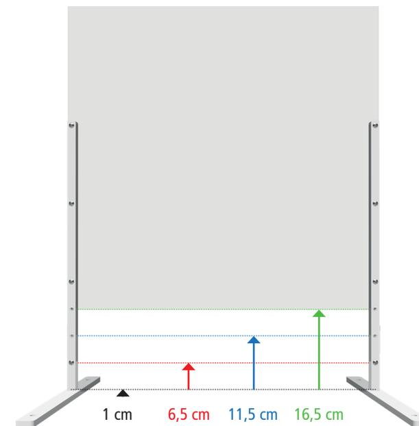
Die **Durchreichhöhe** kann nach Bedarf in 4 verschiedenen Stufen eingestellt werden. Minimum ist 1 cm / 0,7 cm zur Kabeldurchführung oder bis zu 16,5 cm für Dokumente, Pakete, Kleidung, etc.
